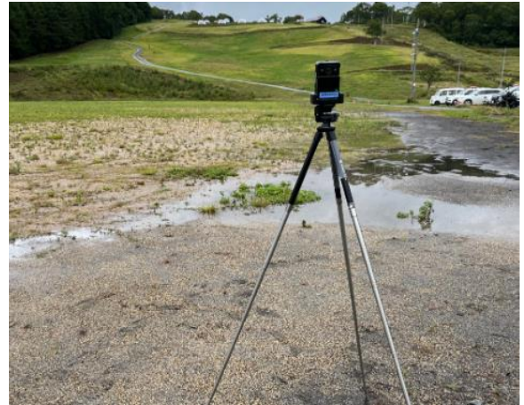
人の待機監視が危険な個所への定点カメラ設置
